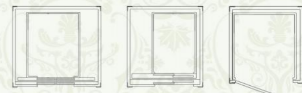
中分式 center-opening 旁开式 side-opening 手拉门 manually operated door
